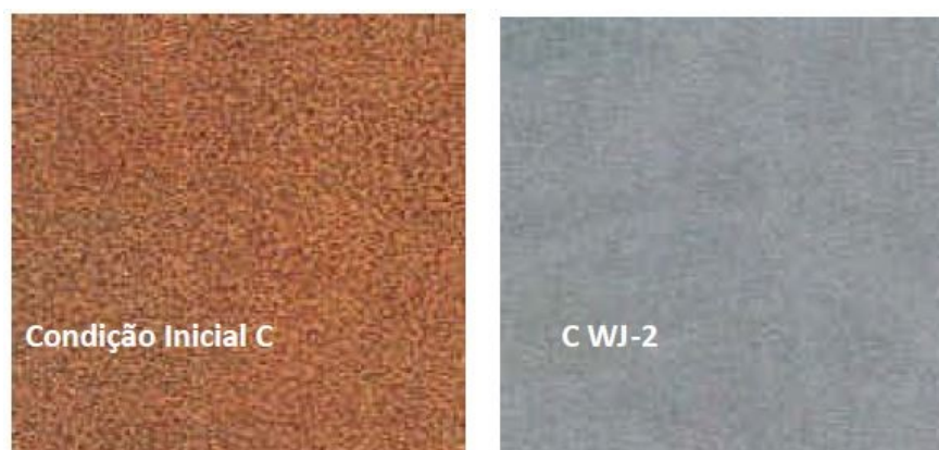
Figura 35 – Níveis de Flash Rust (C-WJ2)
