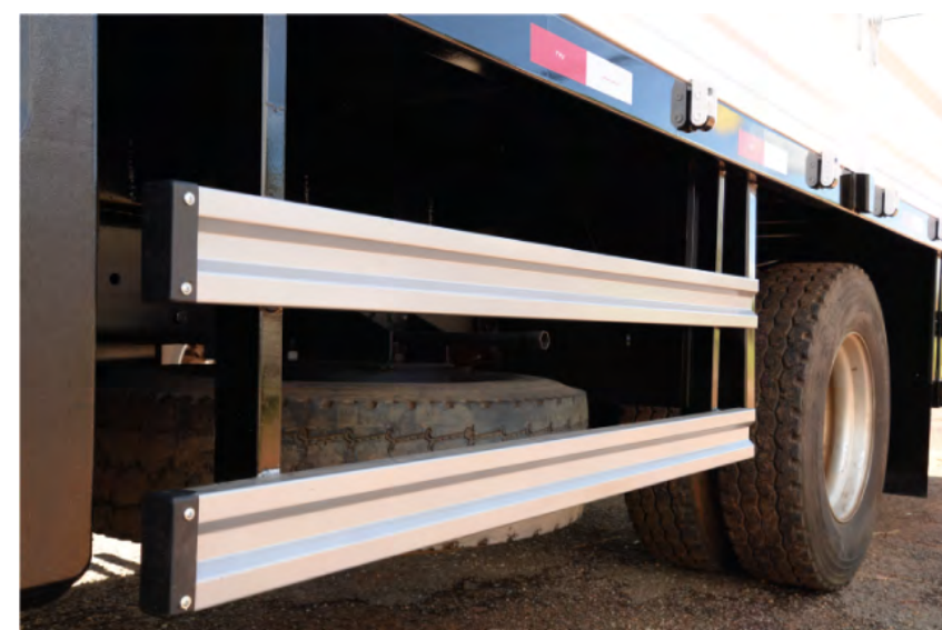
Protetor nas laterais conforme resolução nº 323 do CONTRAN
