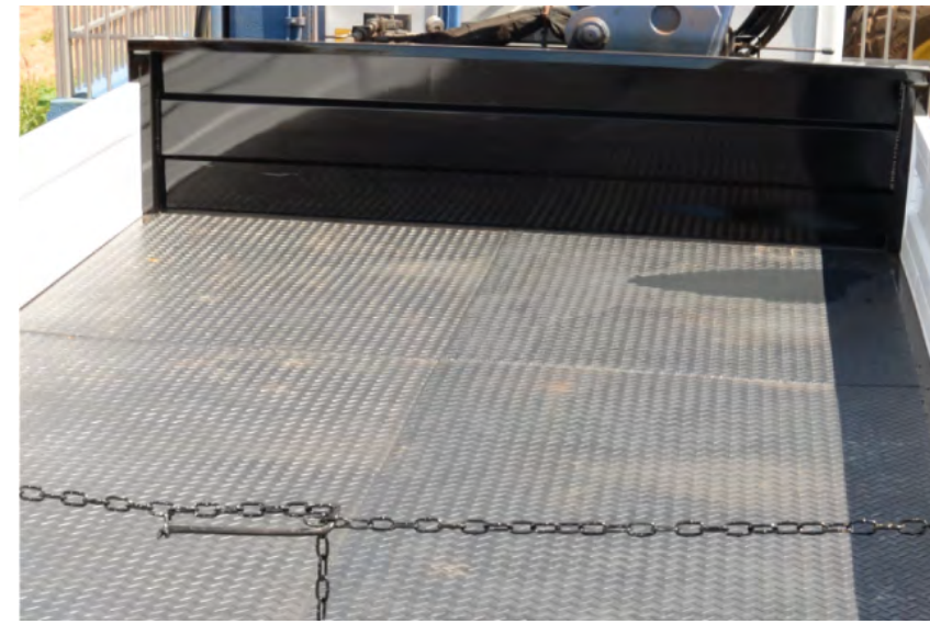
Assoalho em chapa de aço xadrez mínimo de 3,00mm com pontos internos para amarração de carga
