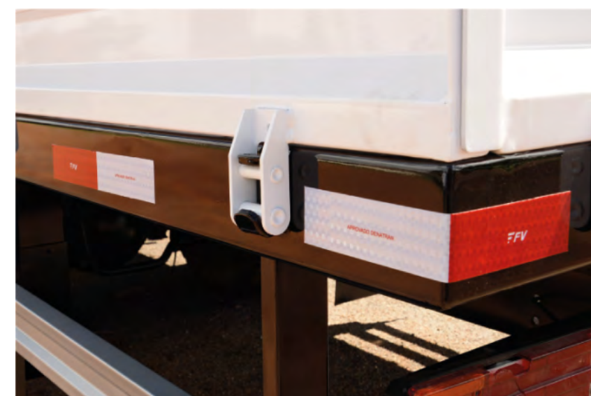
Faixas refletivas conforme resolução 128 do CONTRAN
