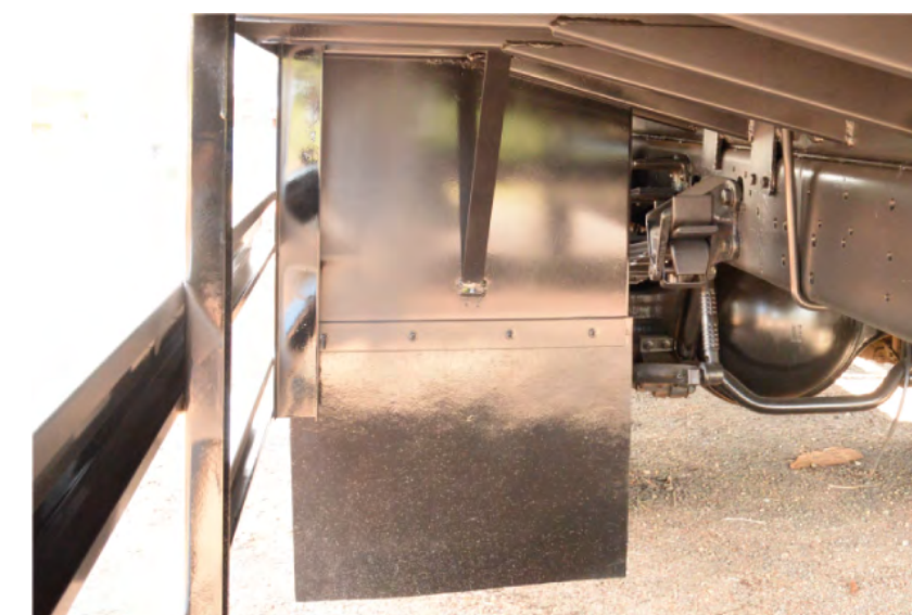
Para-lamas de aço com para-barro de borracha
