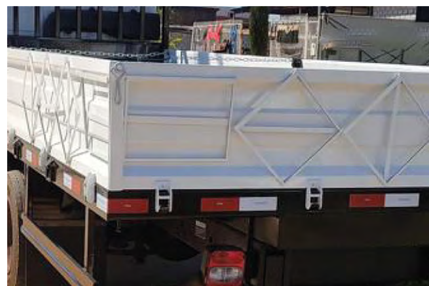
Laterais na chapa dobrada de 2,65mm com 5 tampas (2 em cada lateral e 1 traseira). Com suportes laterais e traseiros de Painel de Segurança e Rótulo de Risco para Transporte de produtos perigosos
