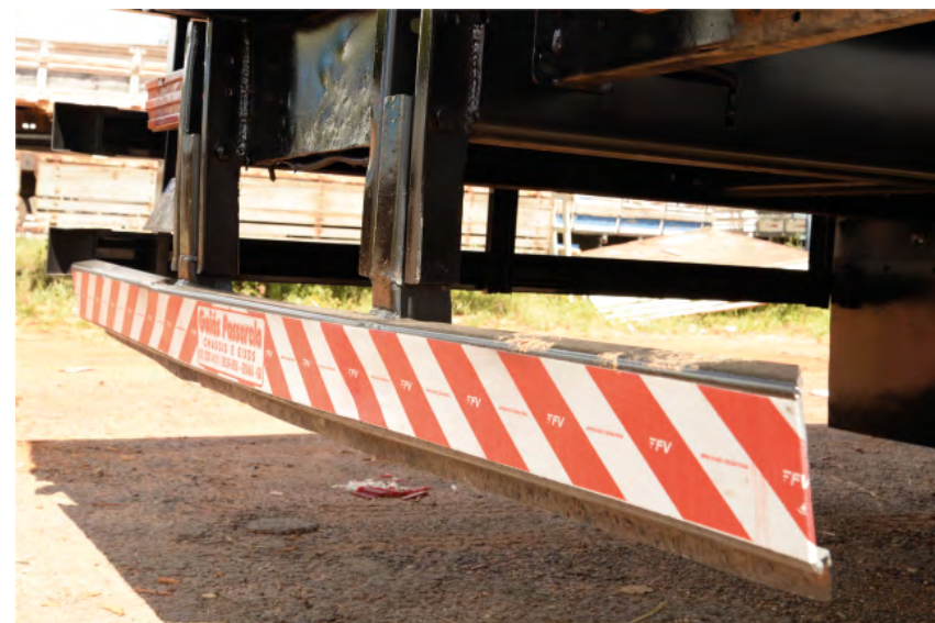
Para-choque traseiro aprovado pelo INMETRO com faixa refletiva, e demais exigências da legislação de trânsito
