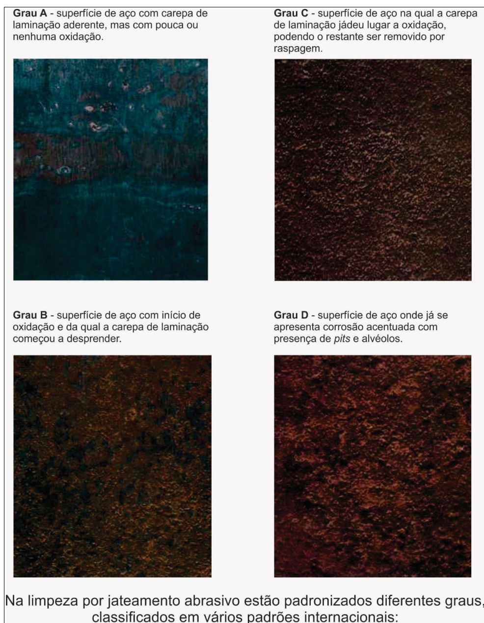
Figura 25 – Graus de oxidação
