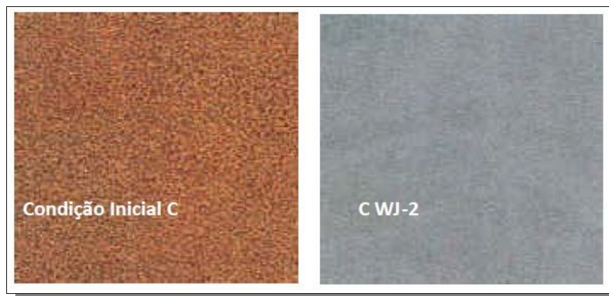
Figura 34 – Níveis de Flash Rust (C-WJ2)
