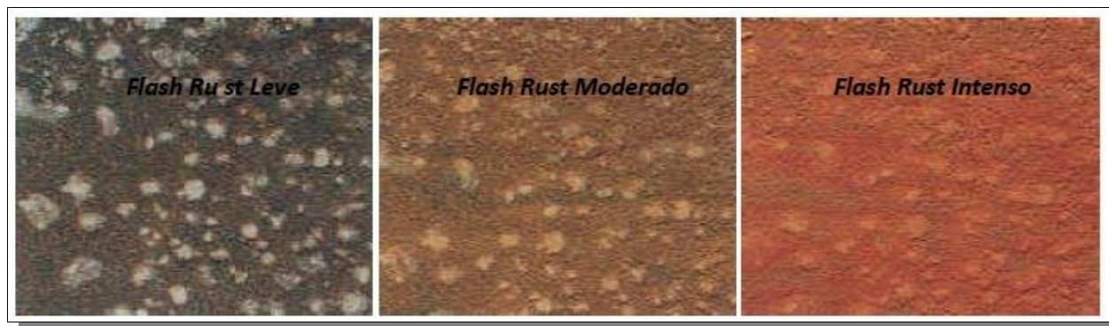
Figura 37 – Níveis de Flash Rust (D – WJ3)
