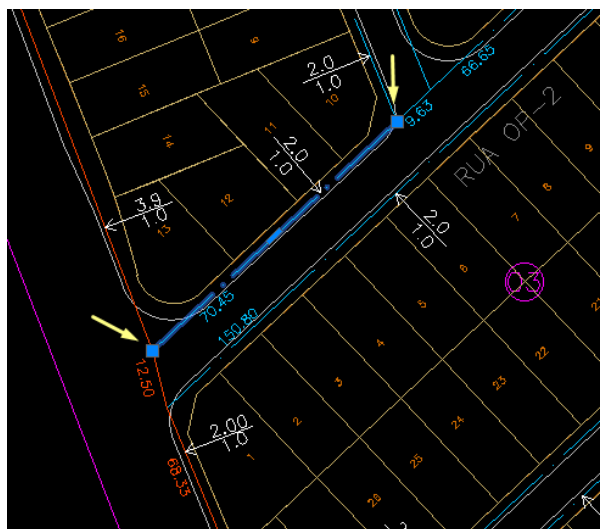
Figura 2: Representação da vetorização, com pausa nos locais com presença de interligação
