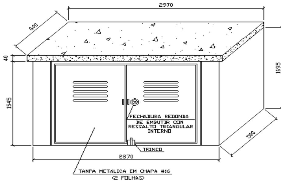
DETALHE PARA INSTALAÇÃO DA TANPA DA CAIXA
