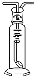
Figura 2 – Frasco lavador de gases com tampa de junta esmerilhada e difusor de bolhas de vidro sinterizado
